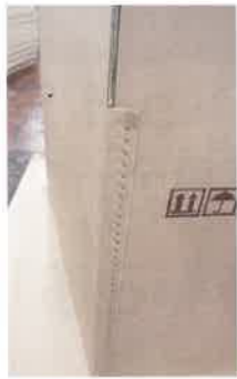
ステッチャー部分への段潰し加工。これまでは手加工で行っていたものが機械化され、効率が数段アップ
