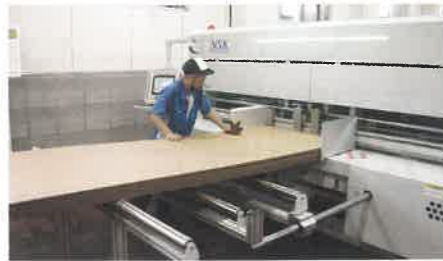
給紙はボトムフィード方式を採用。反りのある材料を安定供給するリードエッジフィーダーを搭載
