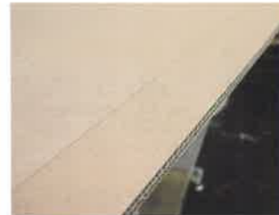
IBでは縦・横共にシャープな加工断面を実現している
