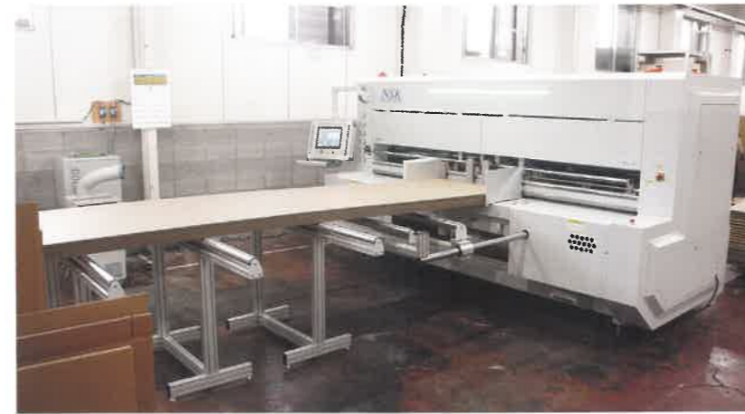
国内初導入となる IB-3000HD。最大 16mm 厚の強化段ボール加工に対応する最上位スペック
